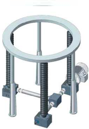
Apoyo en tres puntos determinado estáticamente de un dispositivo lapeador y pulidor.
